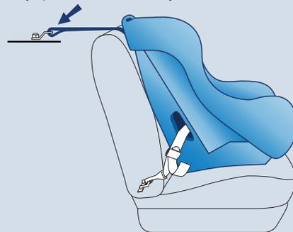
La correa de sujeción debe estar correctamente enganchada y firmemente ajustada para que proporcione la mayor protección posible. Puedes encontrar los puntos de anclaje para la correa de sujeción en el manual para el propietario de tu vehículo y en las instrucciones de instalación de la correa de sujeción, en el manual de tu car seat.
